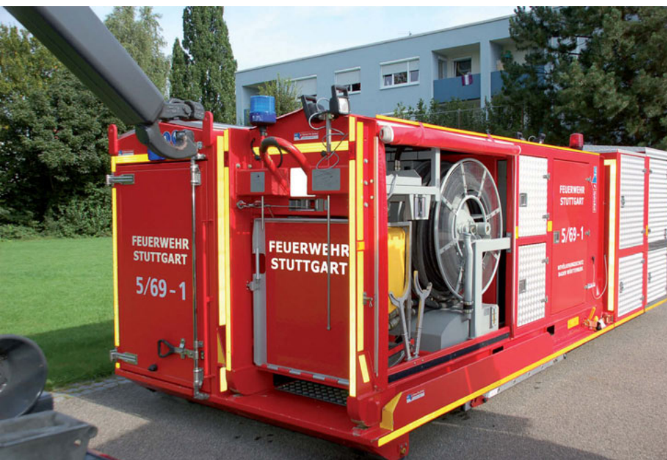
Abrollbehälter Wasserförderung (Landesbeschaffung)
